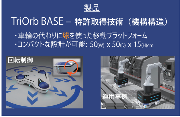
球体を用いた移動プラットフォーム「TriOrb BASE」
