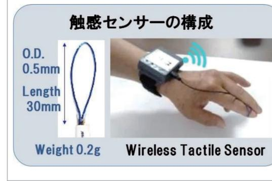
触感センサー手袋とウォッチ型無線通信アンブおよびモニタリングシステム
