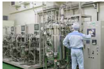
発酵・培養 pHや温度をコントロールして菌を発酵・培養します
